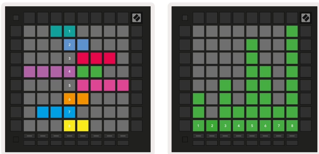
5.4.9.A – Fader dla panoramy ścieżki (po lewej) i głośności (po prawej)
