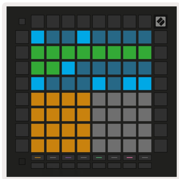
9.2.7.A – Długość bramki dziewiątego kroku w tym pattern jest ustawiona na 10 kroków, co wskazują 10 zielonych podkładek.
