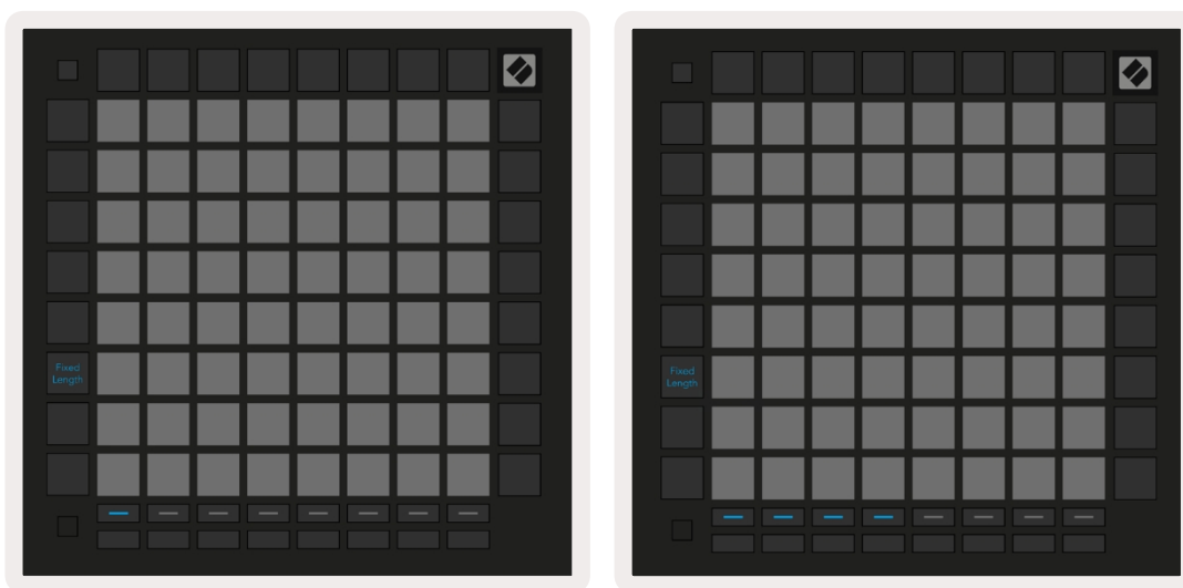
5.3.7.A – Ustawianie liczby taktów za pomocą przycisków wyboru ścieżki dla stałej długości. Stała długość 1 taktu jest widoczna na lewym obrazku, a 4 takty na prawym.
