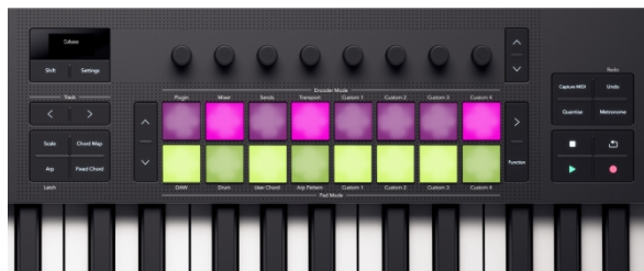
Pady Launchkey 37 odzwierciedlające stany wyciszenia i solo miksera na padach.
