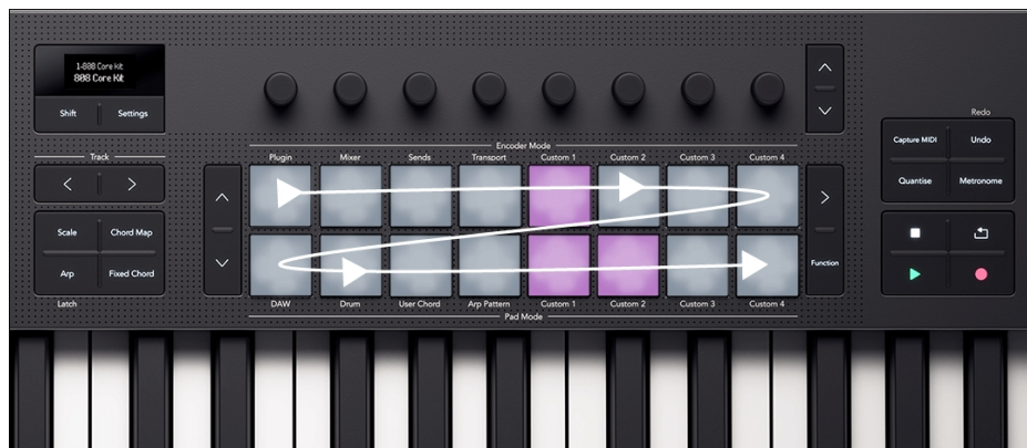
Układ padów ze strzałkami wskazującymi kierunek sekwencera
