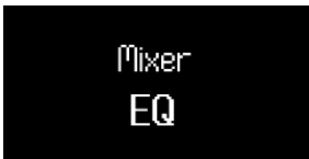
Przechodzenie do trybu enkodera korektora miksera programu Logic.
