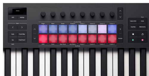
Pady Launchkey 25 odzwierciedlają wybór utworu i stan gotowości do nagrywania na padach.
