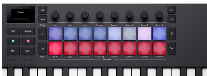
Pady Launchkey Mini 25 odzwierciedlają wybór ścieżki i stan gotowości do nagrywania na padach.
