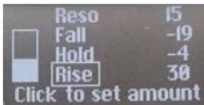
Wyświetlacz przypisania makra do przeglądania slotów modulacji. Bieżący slot jest otoczony ramką.
