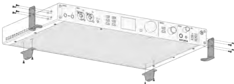
AudioFuse 16Rig skonfigurowany do użytku stołowego
