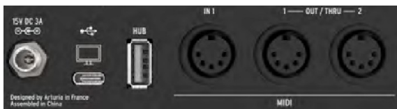
Złącza MIDI, USB i zasilania na panelu tylnym
