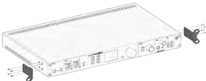
AudioFuse 16Rig skonfigurowany do montażu w szafie rack
