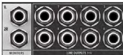
Wyjścia audio na panelu tylnym, z wyjściami głośnikowymi po lewej stronie
