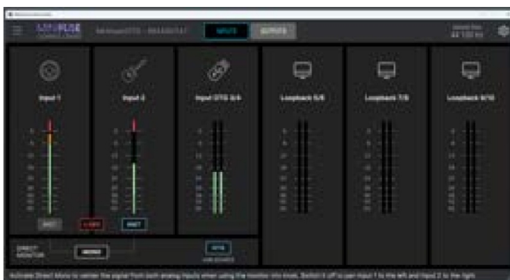
Zakładka „Wejścia” w systemie Windows, z pomiarami dla wejść fizycznych, OTG i pętli zwrótnej, które są następnie wysyłane do powiązanych z nimi wyjść (jak wyjaśniono w rozdziale „Nagrywanie pętli zwrótnej”).
