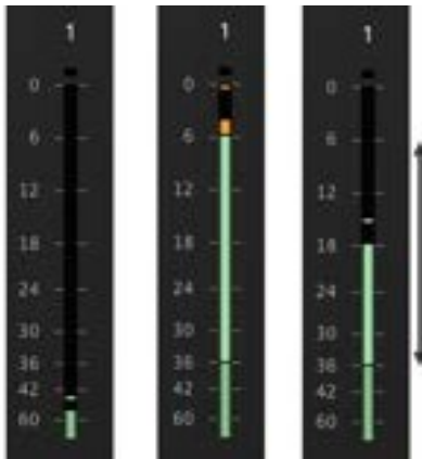
Ustawienia poziomu. Od lewej do prawej: zbyt niski, zbyt wysoki (zniekształcony) i idealny
